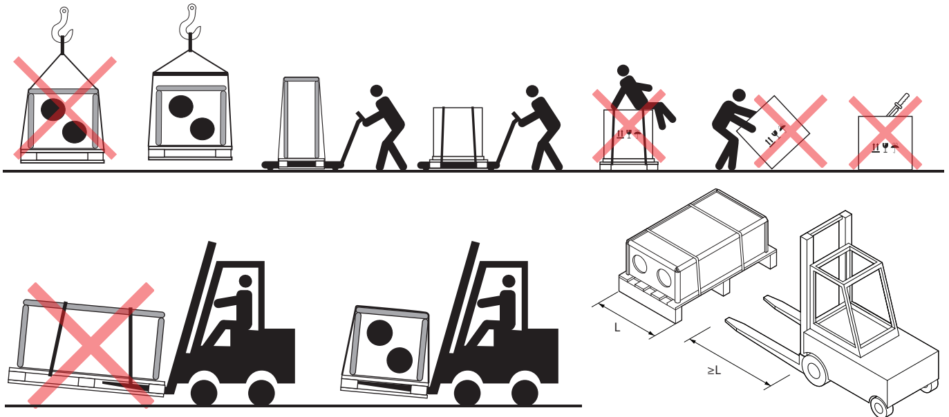
Afb. 4. Voorbeelden van verplaatsing per kraan, vorkheftruck en pompwagen.
