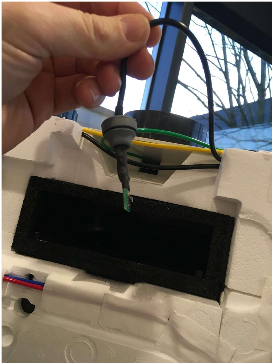
6. Trek de overeenkomstige stekker van de print om de sensor helemaal te verwijderen. Plug de nieuwe sensor in op de zelfde plaats, en leg de kabel in de voorziene kabelgoot. Overtollige kabel lengte kan in de uitsparing bij de sensor zelf gestoken worden.
